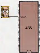
A través del pin número 6 recibe el Z80 la señal de reloj.
